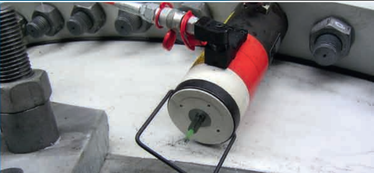
Modello multistadio per spazi ristretti. Disponibili anche in versione 800Bar per l'utilizzo con centraline a bassa pressione.
